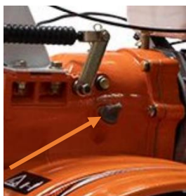
Fig. 5 – Verificarea nivelului de ulei al transmisiei
